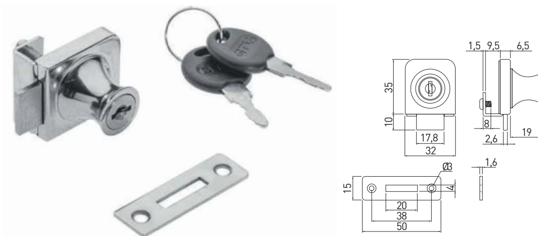
SERRATURA PER PORTA IN VETRO CON CILINDRO Ø18X19MM
